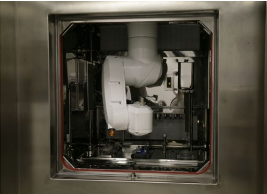
“Theodorico”, braço robótico que realiza a manipulação do produto
